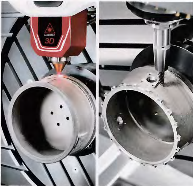
Technologieintegration von DMG Mori: Laserauftragschweißen und 5-Achs-Fräsen intelligent kombiniert.
