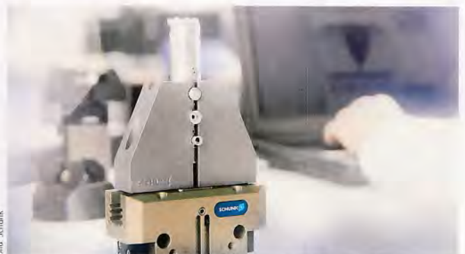
Technologievorteil durch Additive Manufacturing: Die eGRIP Metallfinger von Schunk verfügen über eine integrierte Hohl- beziehungsweise Gitterstruktur, die Gewichteinsparungen zwischen zehn und 50 Prozent ermöglicht.
