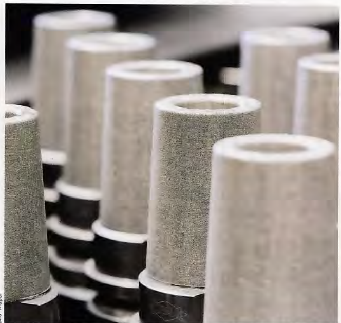
Teilweise additiv gefertigtes Hydrodehnspannfutter von Mapal: Ohne Lötstelle ist es deutlich temperaturbeständiger als sein konventionelles Pendant.
